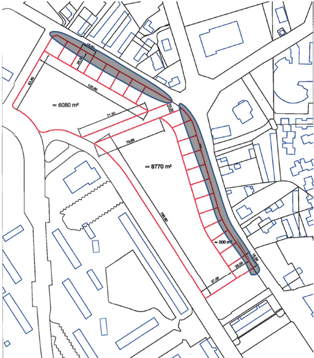
Localisation des reprises voiries côté aménagements NPNRU
